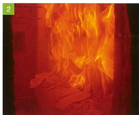
写真①の○部から見える内部の様子。釜の内部で 800℃～950℃の炎にさらされています。
