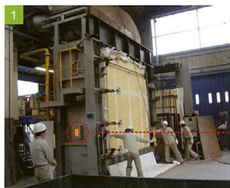
防火試験風景。 釜にセットされたECOボード。
