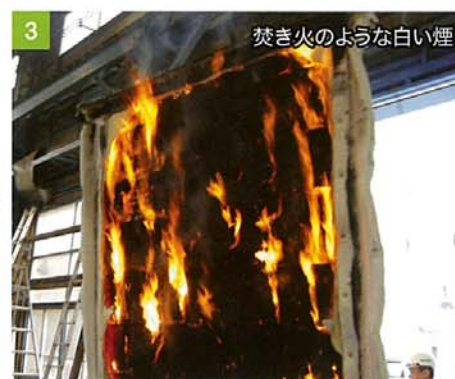
30分後、釜から取り外したECOボード。 外壁から脱落する事無く燃えながら残っています。
