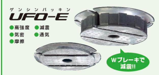
UFO-Eは、建物と基礎の間に設置する「減震パッキン」で、 地震の大きな揺れが建物に直接伝わる前に 摩擦のブレーキで揺れを小さくして減震します。 結果、建物へのダメージや家具の転倒も軽減します。
